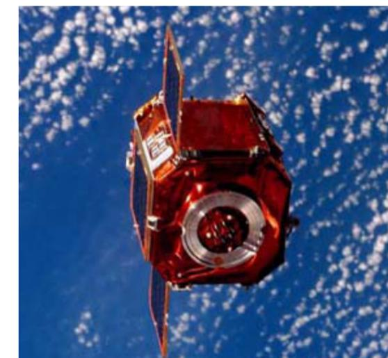
SAC-A en vuelo con paneles solares desplegados
